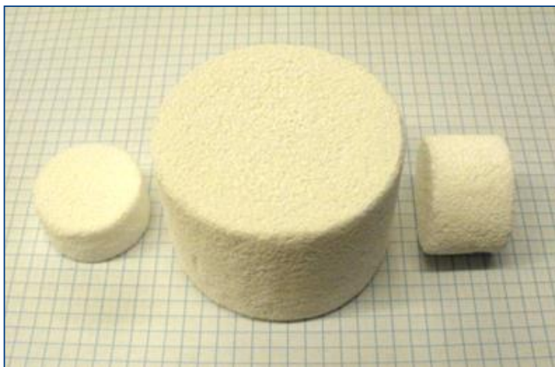
Pianki ceramiczne przeznaczone do infiltracji metalem
