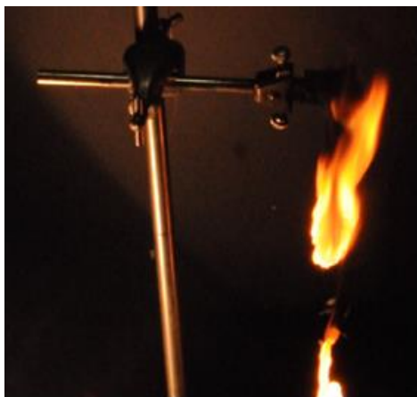
Próbka odlana z handlowej żywicy epoksydowej i próbka odlana z samogasnącej kompozycji epoksydowej według wynalazku.
