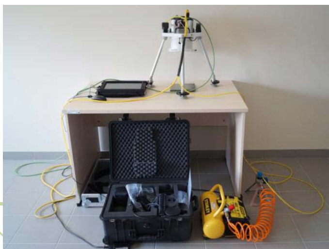
Rysunek 3. Termowizyjny system do inspekcji konstrukcji kompozytowych.
