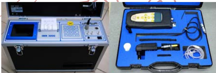
Rysunek 14. Przenośny analizator spalin IMR 3000 oraz analizator biogazu.
