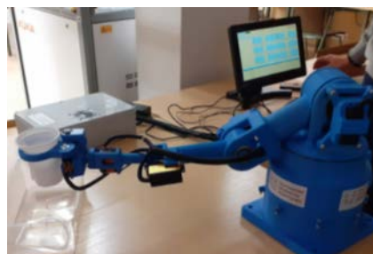
HUMERO – ramię robota skonstruowane przez studentów WMT.
