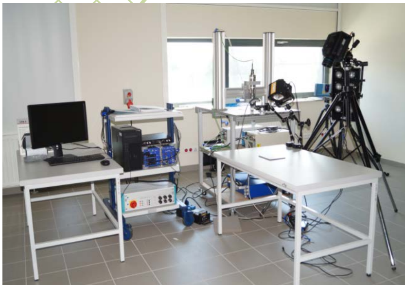
Rysunek 2. Termowizyjny system do badania materiałów kompozytowych.
